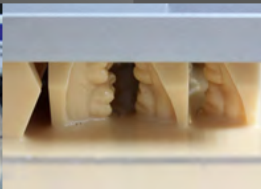
12 & 13 Modelldruck auf dem envisionTec-Drucker Vida. Die darin verbaute industrielle UV LED-Lichtquelle belichtet dabei das Harz im sogenannten Maskenbelichtungsverfahren – und zwar nicht punktuell, sondern Schicht für Schicht.
