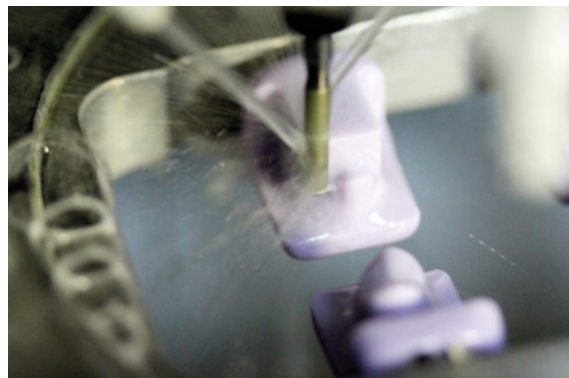
Abb. 4: Schleifvorgang bei Fertigung einer Krone aus IPS e.max CAD.
